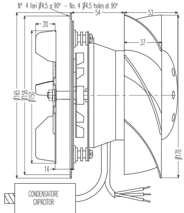
Un'idea, una duplice soluzione per la doppia funzionalità dell'estrattore fumi e ventilatore ST73 V2. Contemporaneamente aspira i fumi di combustione dalla ventola anteriore Ø 150 mm e, grazie alla ventola posteriore nera, fa circolare l'aria calda da immettere in ambiente.
